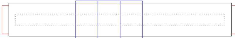
赤は滑尺、黒は固定尺、緑は透明のシートで、青は透明シートで作ったカーソル、点線は固定尺に開けた窓です。固定尺の部分が滑尺を包み込む形になります。
