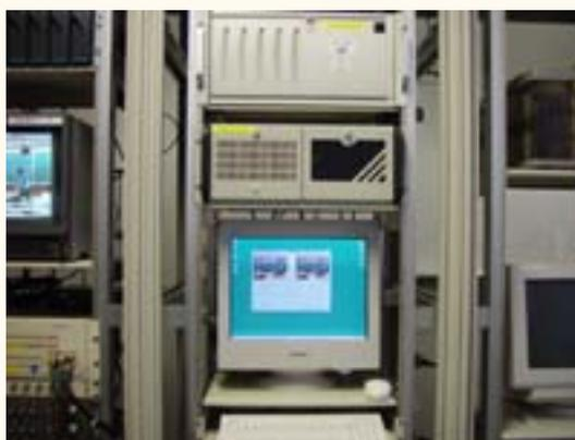
ビデオ機器室に設置しているリアルサーバ、Windows Media サーバを使って、大講義室、117, 123, 270教室で撮影された映像をリアルタイムで中継することができます。サーバの設定により中継の範囲を東大内、日本国内、全世界等指定することができます。
