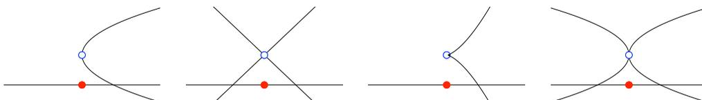
左から順に,  $d = 1, 2, 3, 4$  の場合である. 横線は状態  $s$  をパラメータとした複素数全体  $\mathbb{C}$  を表し, 上の曲線が  $X$  を表す. 上の丸で囲われた点が ramification であり, 下の塗り潰してある点が branch, すなわち稀に起こる異常状態である. 行列  $A(s)$  は,  $s \neq 0$  なら固有値を二つ持っている. 上記のグラフによって, 確かに branch 以外の点では, ファイバーが 2 点になっている事が視覚的に見て取れる.
