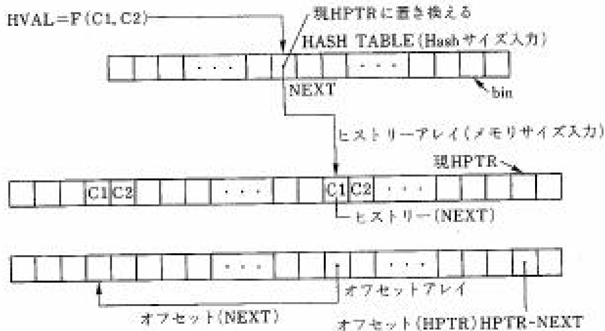
図 1.19 2 バイト文字の Hash 関数による 12 ビット化 [4]
