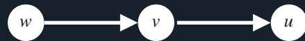
図3. 簡潔に表現された有向グラフの例。グラフは、近傍関数 S, P で表現される。このとき、 S(v) = u, P(v) = w である。
